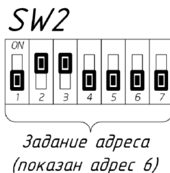
Рисунок 3. Пример установки адреса контроллера переключателями SW2
