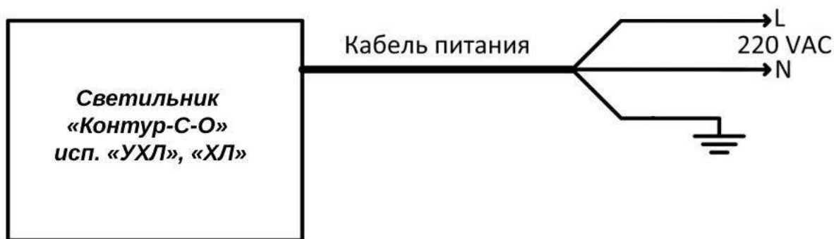
Рисунок 9. Схема подключения светильника «Контур-С-О» исп. «УХЛ», «ХЛ».
