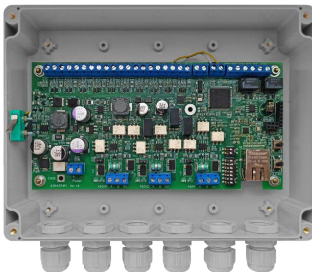
Рисунок 1. Внешний вид контроллера «КЛ-Контур-С» со снятой крышкой.
