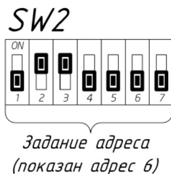
Рисунок 3. Пример установки адреса контроллера переключателями SW2
