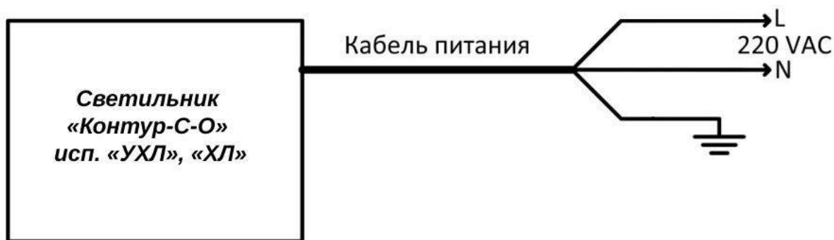
Рисунок 9. Схема подключения светильника «Контур-С-О» исп. «УХЛ», «ХЛ».
